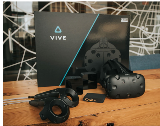
Kuva 4: HTC Vive -virtuaalilasit sekä mukana tulevat ohjaimet ja Lighthouse-paikannusyksiköt (Lee Star, 2018, s. 3).
